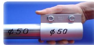
2. Führen Sie die Kupplung nun bis zur Markierung über das Rohr (schmutz- und ölfrei). Anschließend führen Sie das nächste Rohr durch die Kupplung **auf Stoß** heran.
